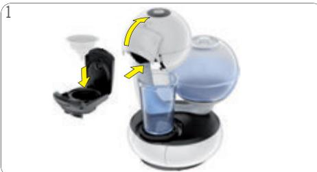
1 Colocar o acessório de limpeza no porta-cápsulas. Inserir o porta-cápsulas na máquina.
