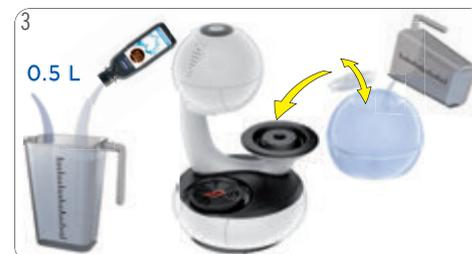
3 Misturar 0,5 litro de água potável com o descalcificante num copo medidor. Verter a solução descalcificante no reservatório de água e colocá-lo na máquina.
